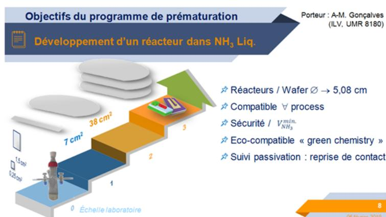
ammoniac liquide permettant la passivation de 1 à 3 wafers d'InP mais aussi des dispositifs optoélectroniques conçus par C2N.
