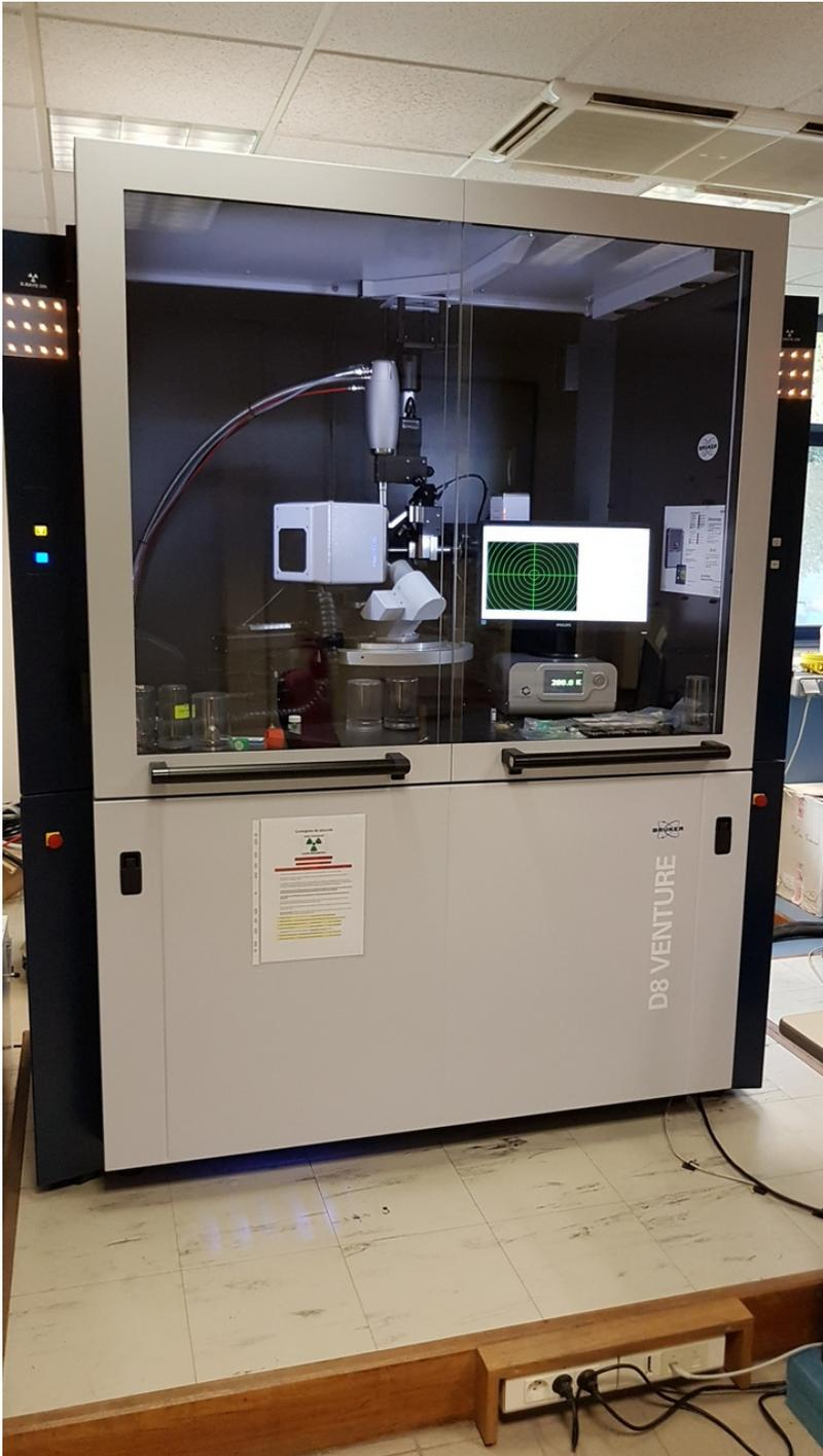
**Diffractomètre monocristal Bruker
