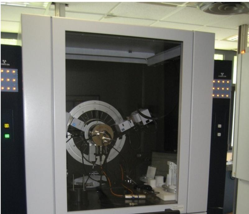
**Diffractomètre poudre Bruker AXS
