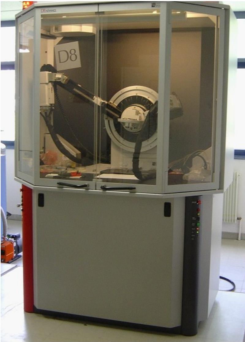
**Diffractomètre poudre Bruker AXS
