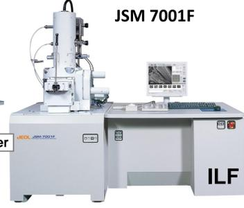
SEM-FEG + EDS - EBSD Imagerie, composition, microstructure, cristallographie
