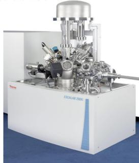
Excitatrices Al K $\alpha$  / Mg K $\alpha$ , haute résolution en énergie, accès aux interfaces enterrées par abrasion ionique séquentielle (Ar $^+$  et Ar $_n^+$ ), UPS, LEIS, REELS + recuit in situ
