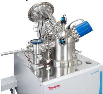
AR-XPS, analyse en profondeur par résolution angulaire (DéTECTEUR 2D)
